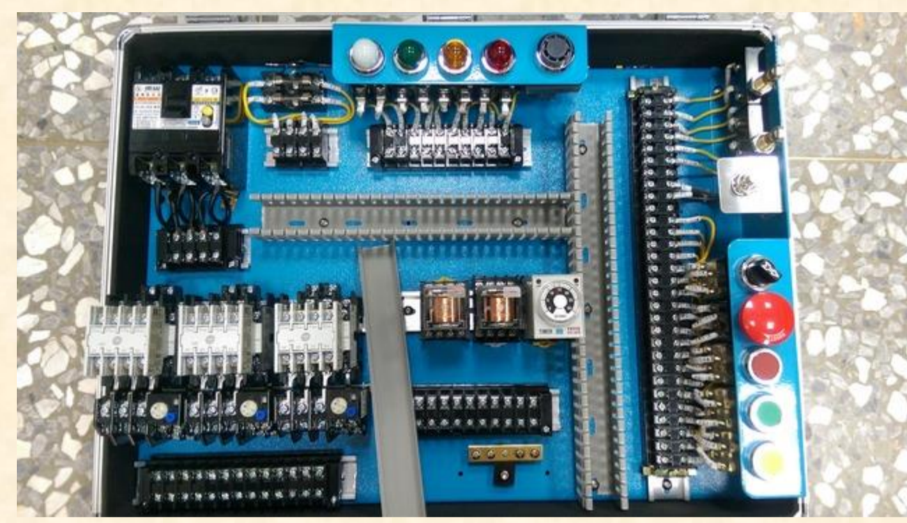
低壓電機控制配線箱
