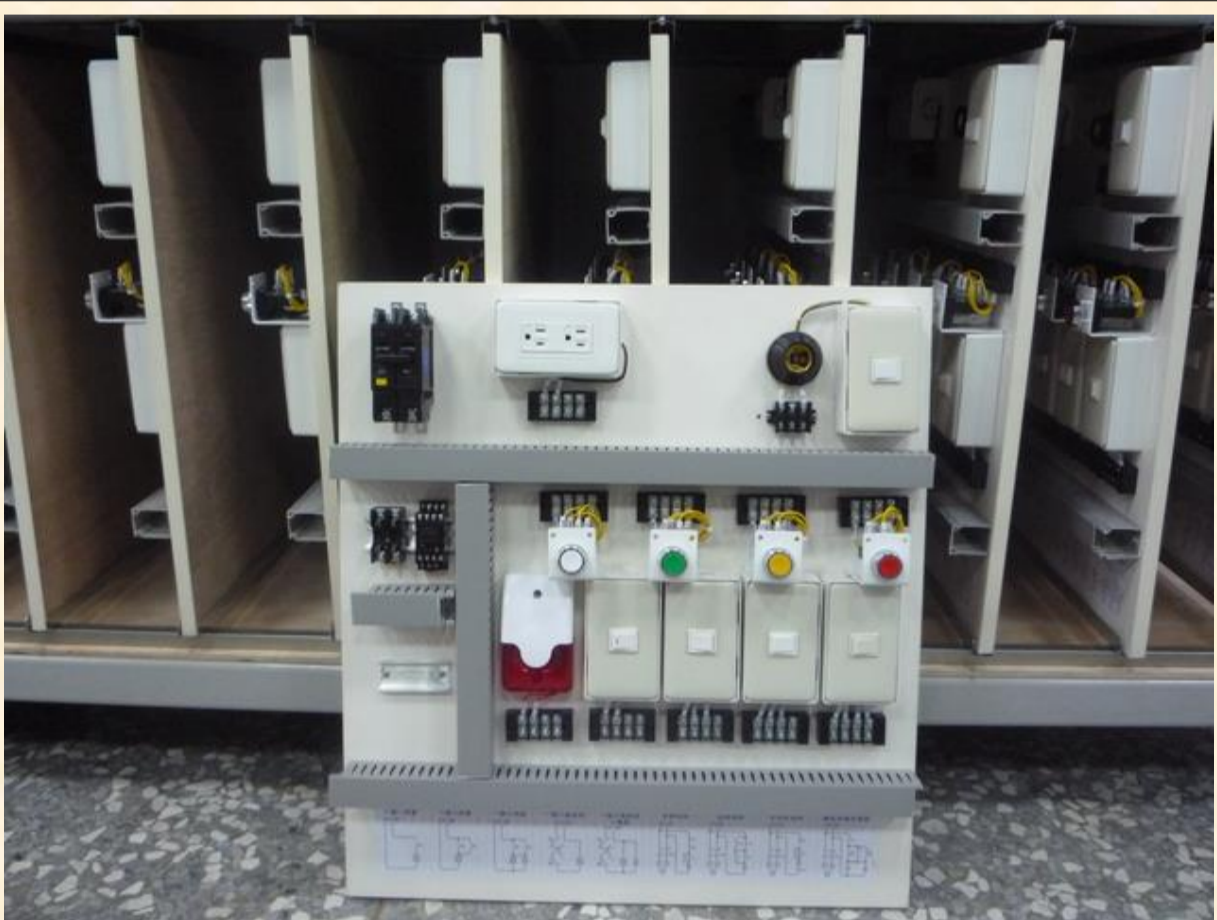
基礎室內配線盤
